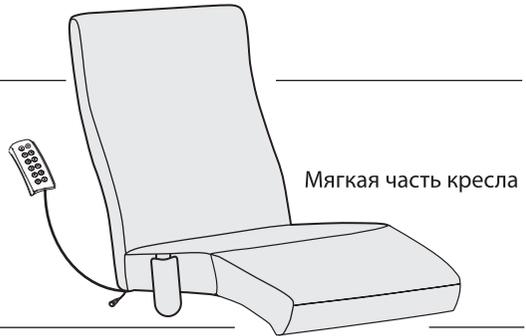
**C** С помощью S-образного шестигранного ключа и крепежных элементов №2 прикрепите опору каркаса к мягкой части кресла как это показано на рисунке
