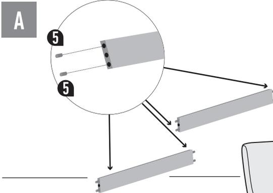
Установите деревянные шканты №5 в крайние отверстия поперечных планок, как это показано на рисунке
